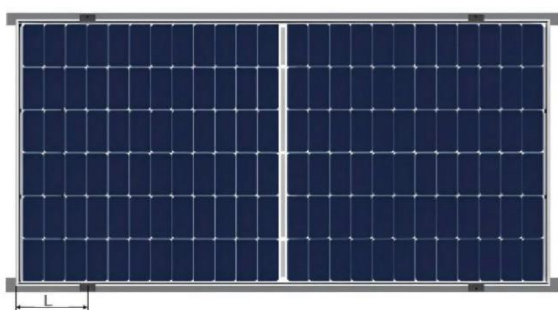
Mocowanie zacisków Szyny montażowe przecinają długą ramę (Metoda 5)
